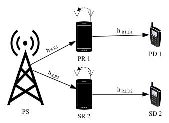
Fig. 1: The CR-NOMA using a TA scheme.
