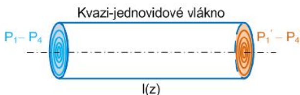
Obr. 8: Naznačení čtveřice výkonů na začátku a na konci kvazi-jednovidového optického vlákna SG1005 při vlnové délce 850 nm.
