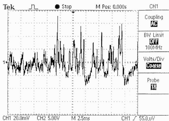
Obr. 7. Priebeh signálu pre "zlú" komutáciu a napájanie snímača z vlastných batérií
