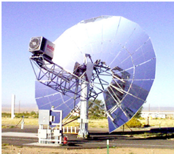
Obr. 1. Jeden z prototypov parabolického solárneho zdroja so solárnym Stirlingovým motorom (USA).
